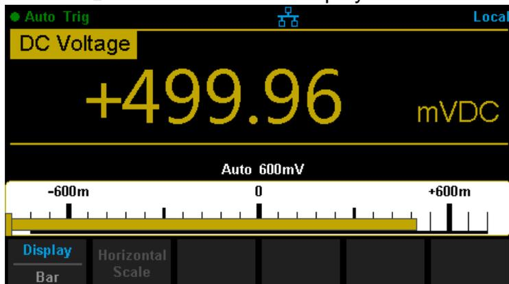
Diagram 2- 64 Bar Meter Display Mode
