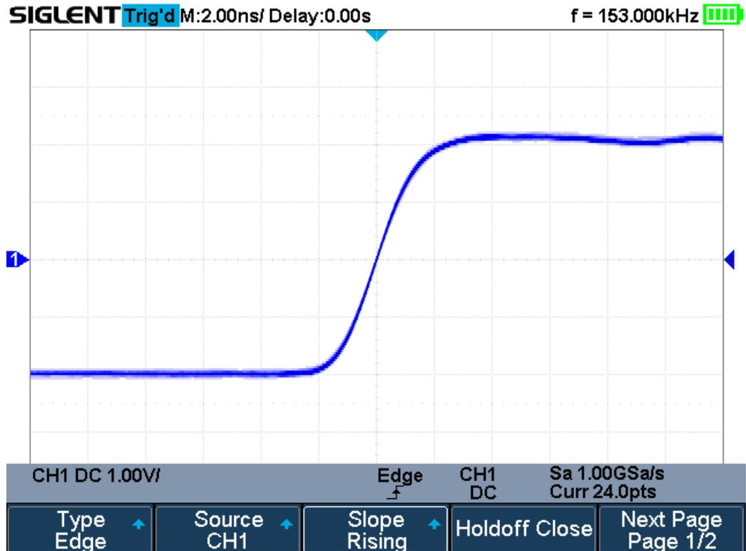
Figure 27 Edge Trigger
