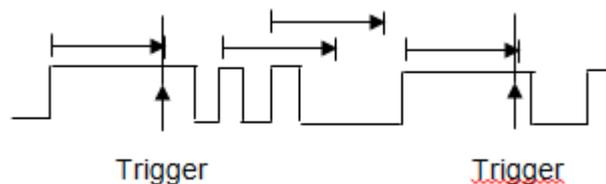
To set edge Dropout trigger:
