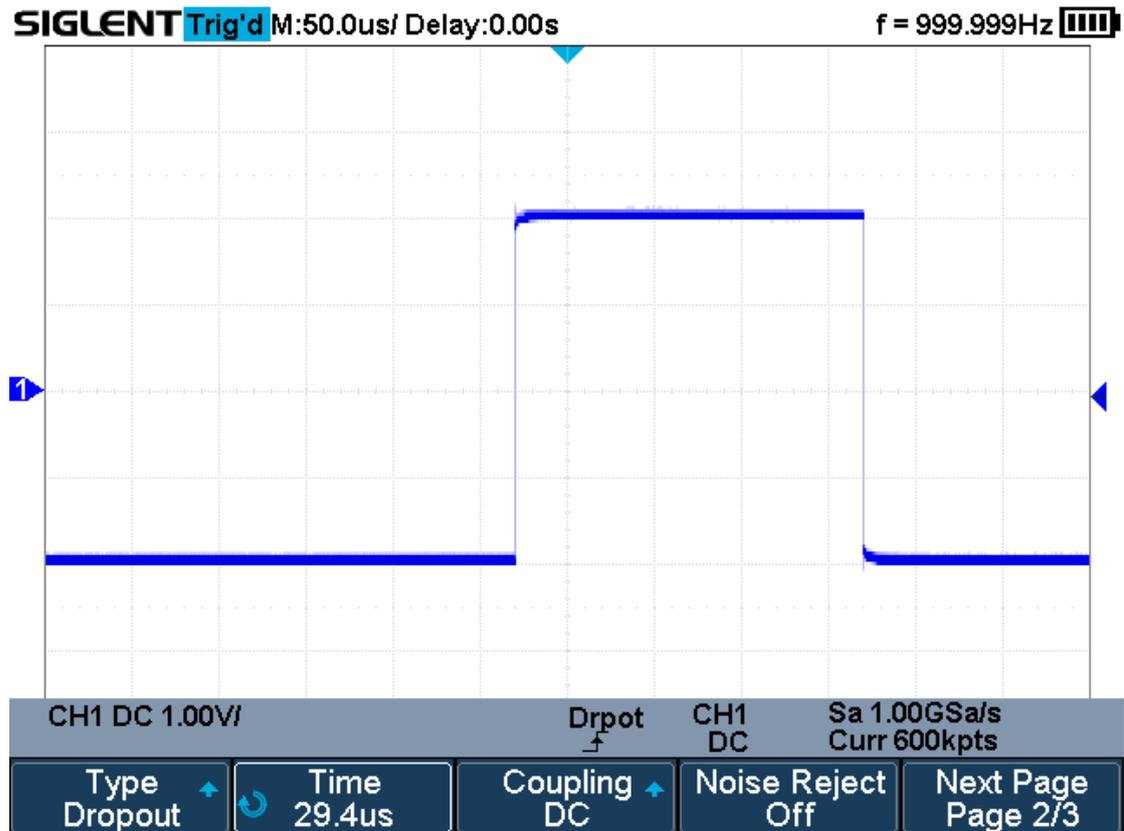
Figure 34 Edge Dropout Trigger
