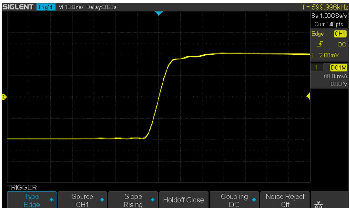
Figure 28 Edge Trigger
