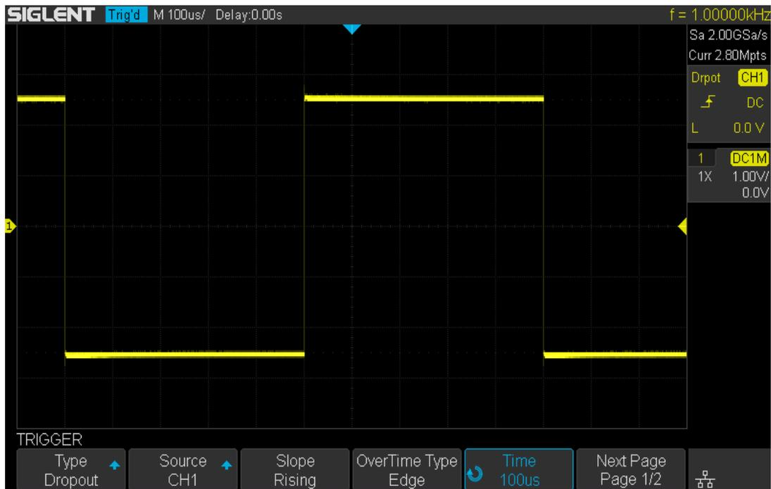
Figure 31 Edge Dropout Trigger
