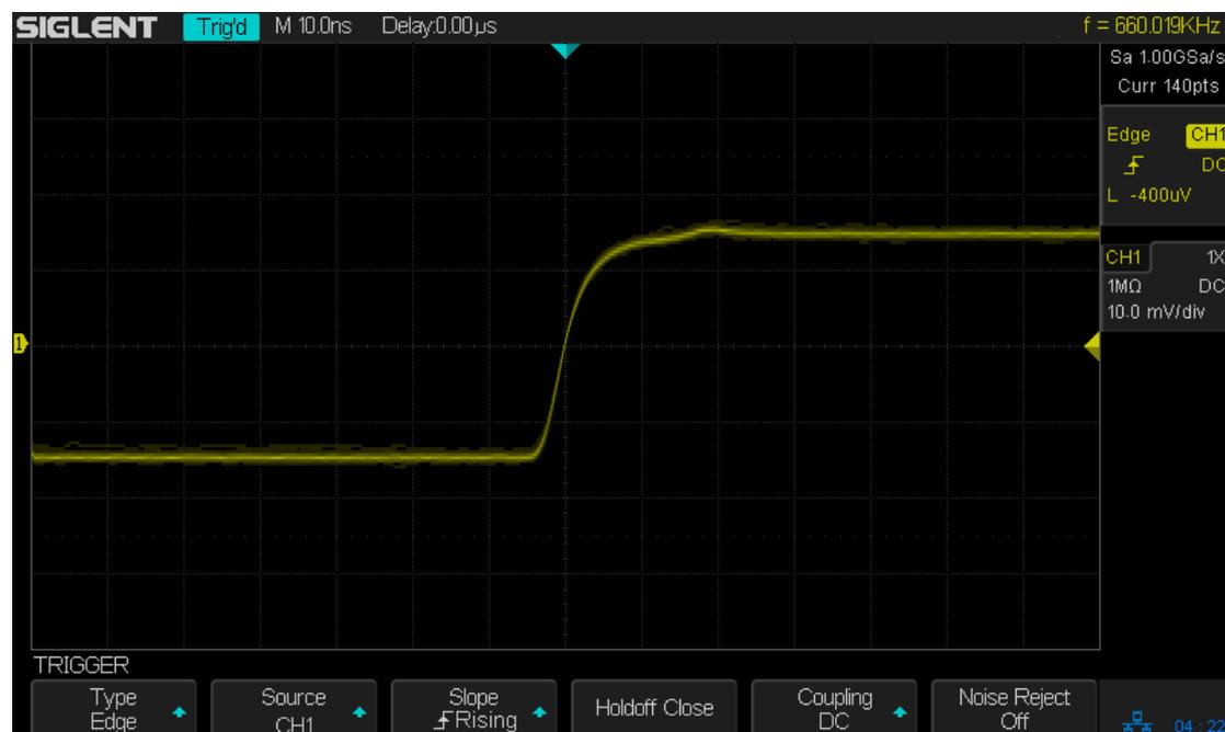
Figure 23 Edge Trigger
