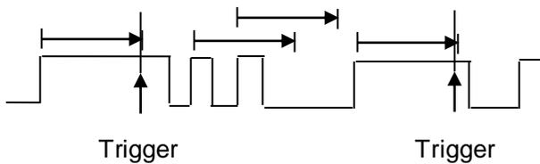
To set edge DropOut trigger:
