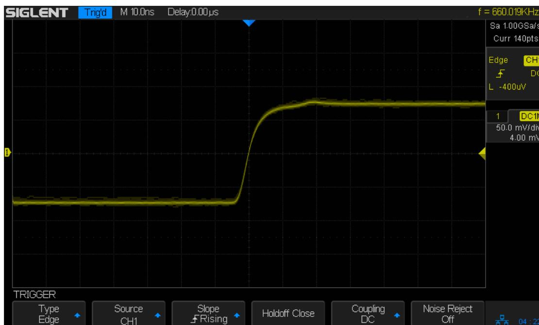
Figure 24: Edge Trigger
